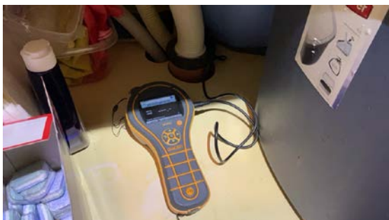
Ved fuktmåletaking av bunn kjøkkenskap var det ikke fuktutslag
