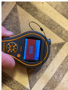
Fuktmåling mot gulv i gangen i underetasjen. Målingen viser store utslag.
