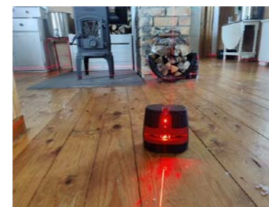
Kontroll av planavvik/skjevheter i gulv.
