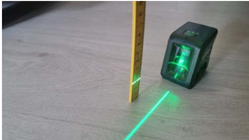
Kontroll av planavvik
