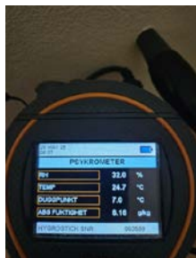
Måling av relativ luftfuktighet i lukket veggkonstruksjon mellom stue og dusjsone.
