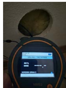
Måling av trefukt i lukket veggkonstruksjon mellom stue og dusjsone.
