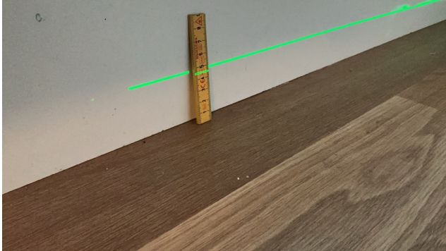
Utgangsstråle fra laser er 40mm
