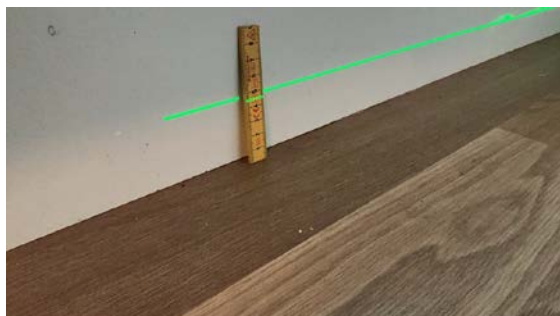
Utgangsstråle fra laser er 40mm
