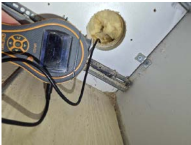
Målt vektprosent under 6% som er tørt tre.
