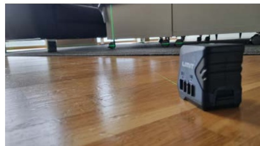
Kontroll av eventuelle skjevheter med krysslaser (hovedetasje).
