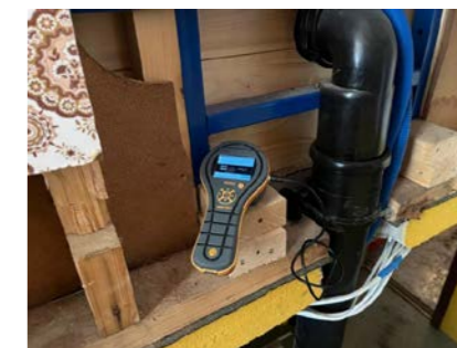
Fuktmåling uten avvik. Ved målinger under 7,8 % vil displayet ikke vise resultat.
