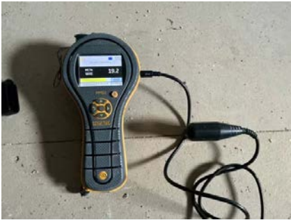
Fukt-søk i gulv med sponplater.
