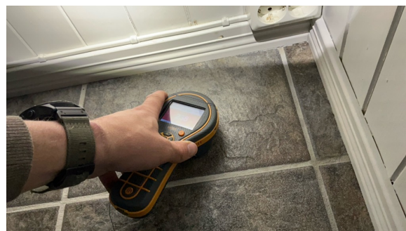
Fuktmåling med hammerelektrode registrerte jeg risikable verdier for fukt. Enkle fuktsøk viste forhøyde verdier.
