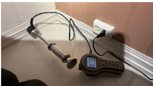
Fuktmåling med hammerelektrode registrerte jeg risikable verdier for fukt. Enkle fuktsøk viste forhøyde verdier.
