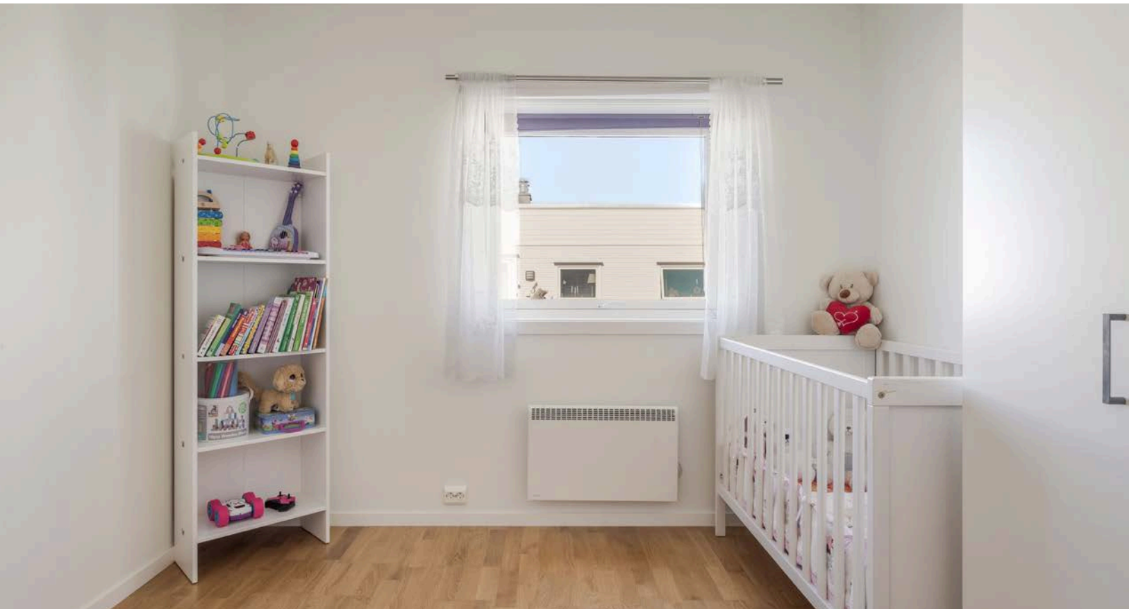
Soverommene varmes opp med elektrisk varme fra panelovner.
