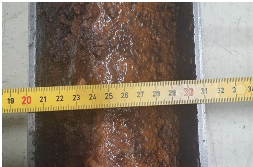
Figur 1: Dimensjoner på røret: OD - 110mm, ID - 100 mm, godstykkelse - 5 mm.
