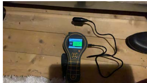
Fuktmåling i tregulv.
