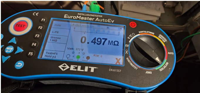
Bilde 1 Lav isolasjonsmotstand på kurs 7.
