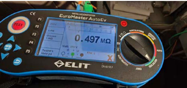
Bilde 1 Lav isolasjonsmotstand på kurs 7.
