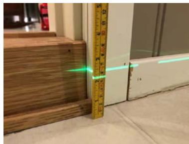
Fall mot sluk er målt med laser.
