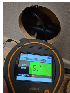
Måling av relativ luftfuktighet i lukket veggkonstruksjon mellom soverom og dusjsone.
