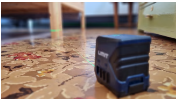
Måling av skjevheter med krysslaser.
