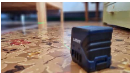
Måling av skjevheter med krysslaser.
