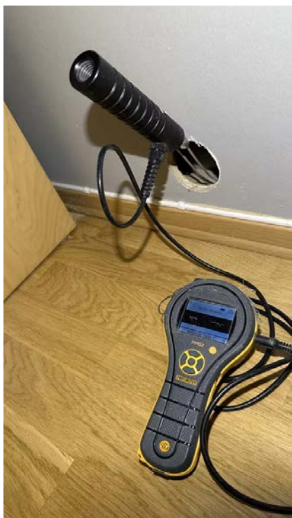
Ingen registrert fukt ved hulltaking.
