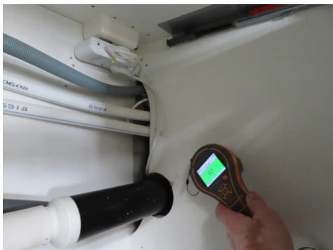
Fuktsøk i benkeskap - ingen påviste forhøyede fuktverdier.
