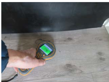
Fuktsøk på gulv foran benkeskap og oppvaskmaskin - ingen påviste forhøye fuktverdier.
