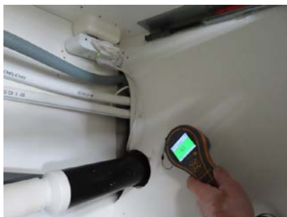
Fuktsøk i benkeskap - ingen påviste forhøye fuktverdier.
