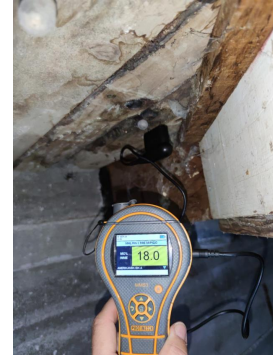
Målt vektprosent på 18 % helt innerst mot sør i krypkjeller.
