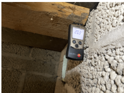
Det måles skadelig fuktinnhold i treverk i krypkjelleren.
