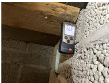
Det måles skadelig fuktinnhold i treverk i krypkjelleren.
