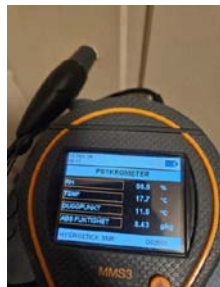
Måling av relativ luftfuktighet i lukket veggkonstruksjon mellom bad og dusjsone.
