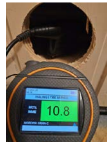
Måling av relativ luftfuktighet i lukket veggkonstruksjon mellom bad og dusjsone.
