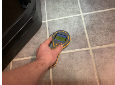
Ved enkle fuktsøk ble det ikke registrert unormale verdier.
