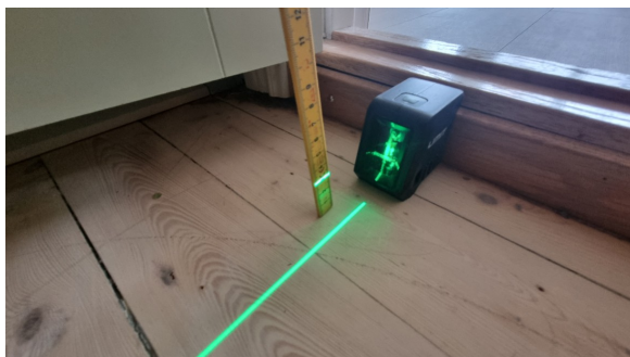
Kontroll av planavvik
