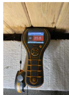
Fukt/svertesopp på panel mot bjelkelaget fra kjelleren.
