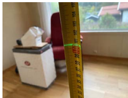
Planavvik med radius på 2 meter.
