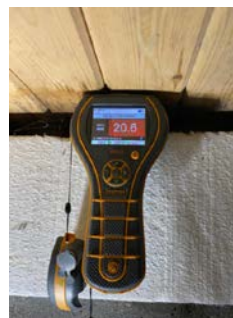
Fukt/svertesopp på panel mot bjelkelaget fra kjelleren.
