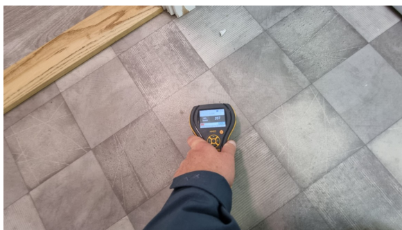
Kontroll av fall og høydeforskjell.
