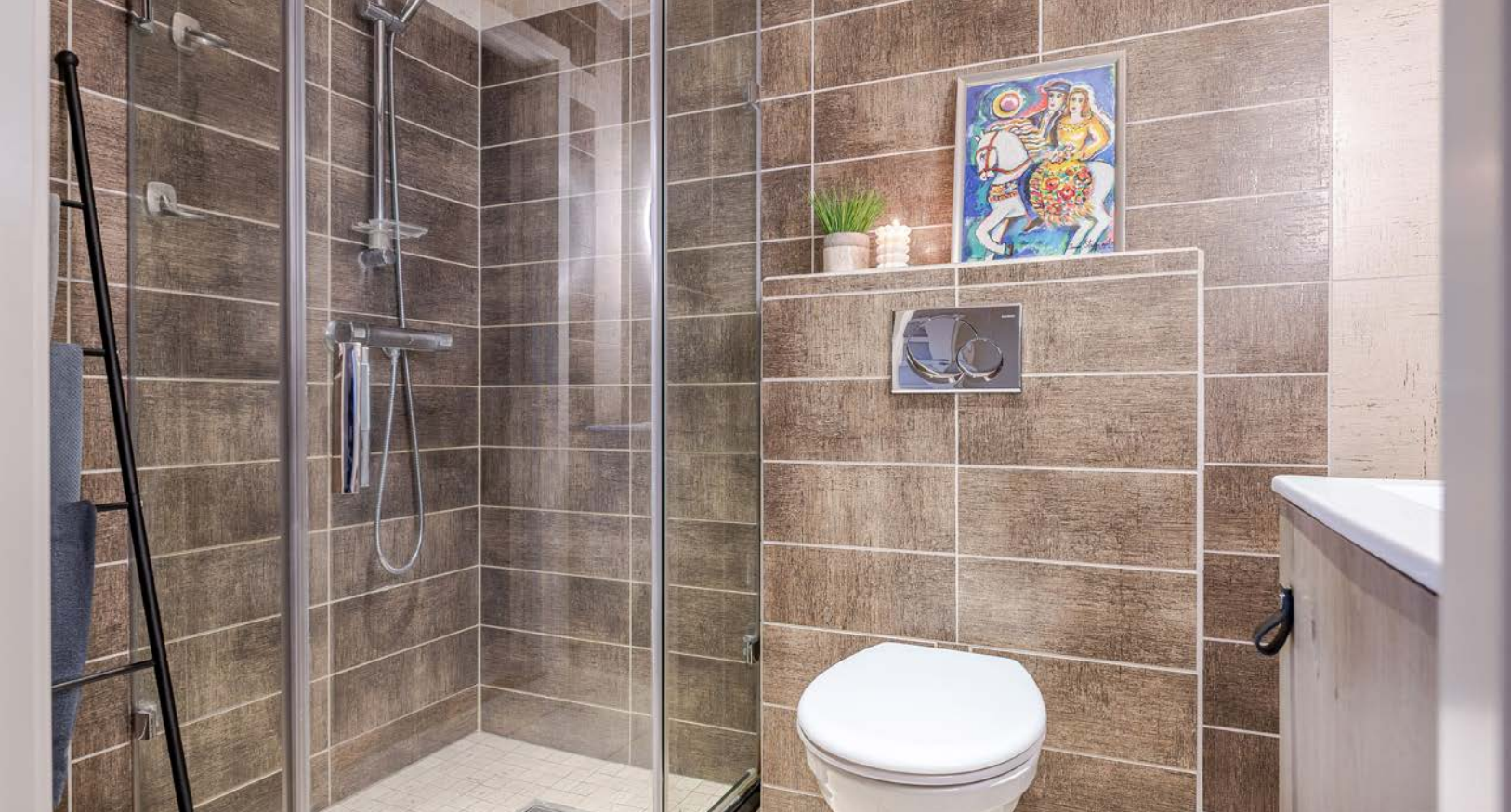
Baderomsinnredningen er fra 2025. Flott baderom 2 med fliser på gulv og vegger, vannbåren gulvvarme, downlights i himlingen og mekanisk avtrekk.
