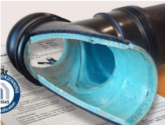
Eksempelbilde av rør som er rehabilitert.
