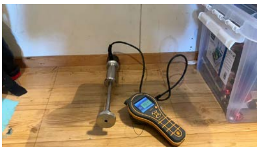
Fuktmåling med hammerelektrode i påforet vegg i innvendig bod viste risikable verdier for fukt.
