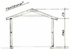
SNITT A-A, TO ROMS GARASJE.
