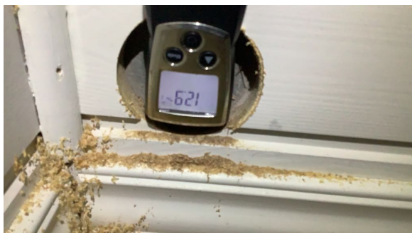
Hulltaking, og det måles tørt.
