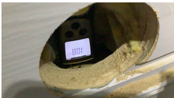
Hulltaking, og det måles tørt.
