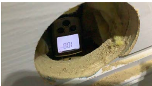
Hulltaking, og det måles tørt.
