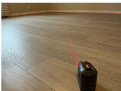
Nivellering soverom, avvik
