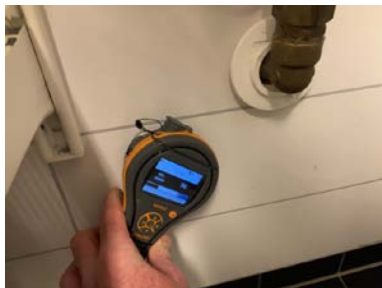
Ved fuktsøk på vegg er det ikke registrert måleverdier som indikerer fukt.
