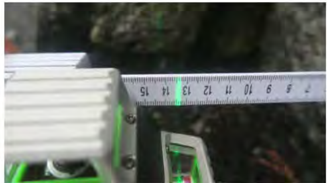
Nede på nordsiden av muren måles 12 cm fra laser.
