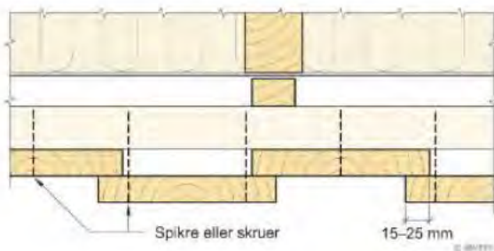
Fig. 551 a Innfesting av tømmermannskledning
