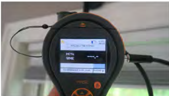
Det ble ikke registrert fukt på befaringstidspunktet. Dette kommer i hovedsak i kaldere perioder og tørker opp på sommeren. Problemet vil oppstå på nytt mot vinteren.
