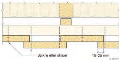
Fig. 551 a Innfesting av tømmermannskledning
