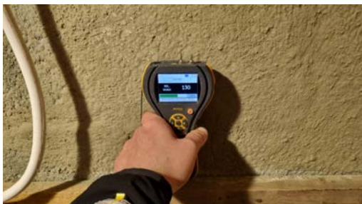
Ingen forhøyde fuktverdier ble registrert.
