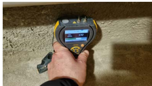
Ingen forhøyde fuktverdier ble registrert.
