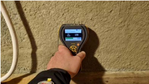
Ingen forhøyde fuktverdier ble registrert.
