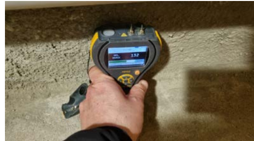
Ingen forhøyde fuktverdier ble registrert.
