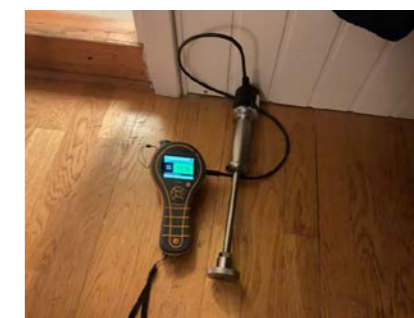
Fuktsøk i svill med hammerelektrode uten unormale resultater.
