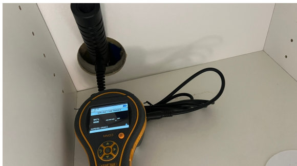
Fuktmåling i veggen mot badet
