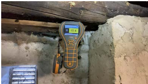
Ved fuktmåling registrerte jeg risikable verdier for skadelig fukt, det indikerer at konstruksjonen er utsatt for fuktpåkjenning.
