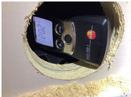
Hulltaking, og det måles skadelig fuktinnhold.
