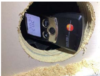
Hulltaking, og det måles skadelig fuktinnhold.
